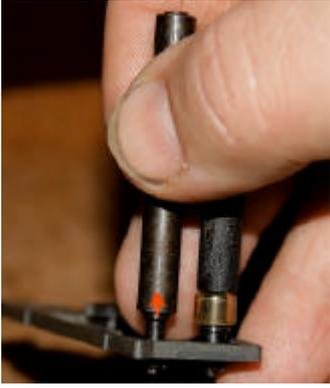
On peut retirer le rouleau (3) du haut pour nettoyer l'axe. On peut également jouer sur max. 3mm en soulevant les rouleaux pour nettoyer le bas de l'axe. Terminer avec une micro-goutte d'huile en haut et en bas de chaque axe, bien essuyer les éventuels débordements d'huile avant le remontage.
