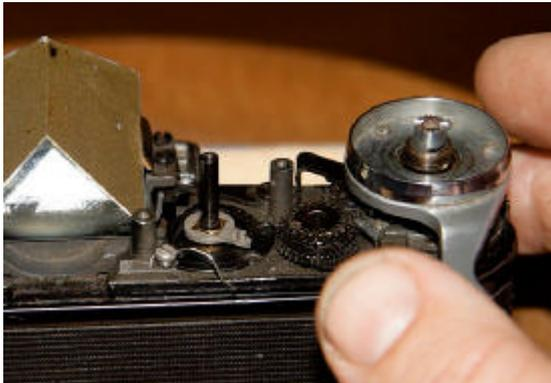
Faire fonctionner plusieurs fois l'obturateur pour permettre aux rideaux de se replacer, et serrer les vis de fixation de la platine de l'obturateur une fois que les différents éléments se sont remis en place.
