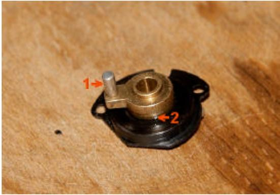
Nettoyer et lubrifier légèrement en 2 et l'axe. Au remontage le doigt 1 doit rentrer en 1 du tambour (image de droite). Cette encoche n'est normalement pas apparente, il faut légèrement faire tourner le centre du tambour et le tenir tendu pendant le remontage.
