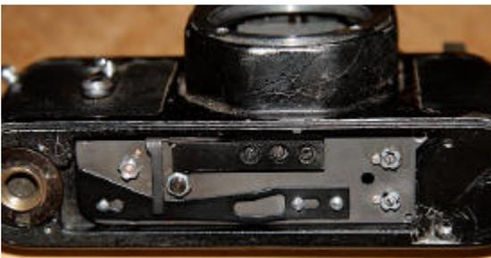
Retirer les vis qui tiennent la platine d'obturateur. Trois ou quatre vis selon le modèle, si 4 vis, la quatrième (tête cône) est en bas à gauche, et il y a une découpe dans le ressort. (arrêter tout et me contacter s'il y a une vis mais pas de découpe!)
