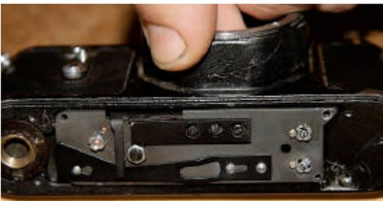
Retirer doucement l'obturateur en poussant depuis l'intérieur du boîtier. Ca peut forcer un peu au passage du cache métallique derrière l'axe du miroir.
