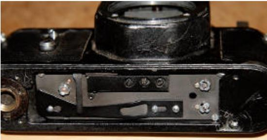
L'obturateur doit être déclenché. Sécuriser l'axe du tambour. J'ai utilisé un petit écrou en guise d'entretoise et une des vis servant à tenir la synchro-flash.
