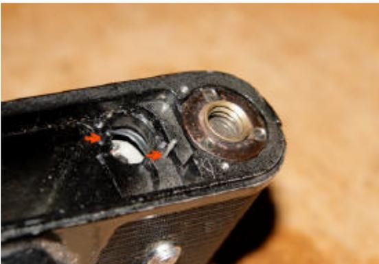
Vérifier le positionnement de ces deux tiges, puis remettre l'obturateur en place, sans forcer. Guider les têtes des axes pour qu'elles reprennent leur place, en passant les doigts par l'intérieur.
