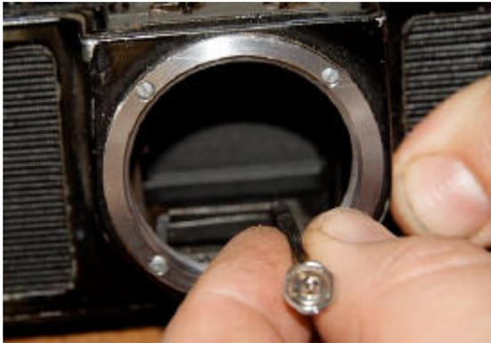
Une fois remonté et revissé le mécanisme de contrôle des rideaux, rattacher le ressort, et retirer la vis et l'entretoise qui retiennent l'axe du tambour.
