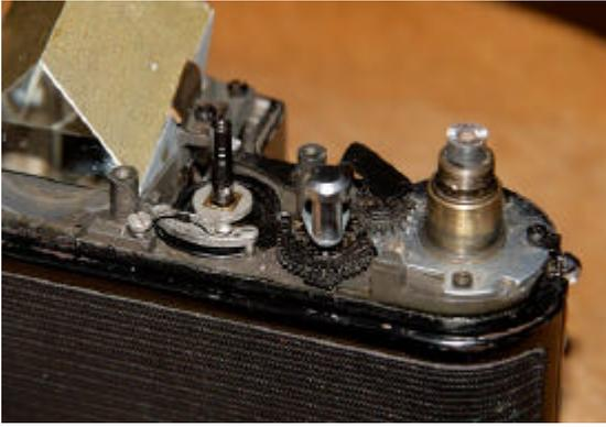
Retirer le bouton de débrayage et le levier de commande du second rideau.
