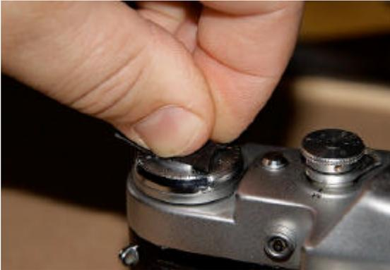
L'écrou supérieur est lisse, j'utilise un carré de caoutchouc (morceau de chambre à air) pour le desserrer. Attention, le pas de vis est "inversé", il faut tourner dans le sens des aiguilles d'une montre pour dévisser. Armer l'obturateur avant de commencer, sinon l'ensemble va tourner.
