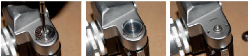
Retirer d'abord la vis de fixation du disque aide-mémoire, puis ce disque et son ressort, avant de dévisser le bouton de rembobinage.
