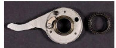
Sous le levier, il y a un premier pignon, entraîné par un cliquet. Généralement, il y a là de la vieille graisse séchée, à retirer et remplacer (je mets de la graisse rose)
