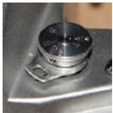
Il vaut mieux retirer le sélecteur de vitesses avant le levier d'armement, ça permet d'armer partiellement pour orienter les vis dans la bonne direction. Aucun repérage n'est nécessaire pour le sélecteur de vitesses, par contre j'ai pris l'habitude de mettre la synchro-flash sur "X", pour retrouver la même position au remontage.
