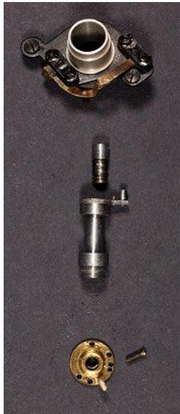
Synchro-flash, sélecteur (là, il est à l'envers!) avec sa vis et son ressort, roue portant des trous correspondant aux vitesses d'obturation et sa vis de fixation.
