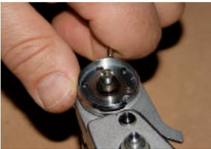
On peut utiliser un petit tournevis pour guider le ressort et le remettre en place, ou une boucle de petite ficelle passée par le trou.
