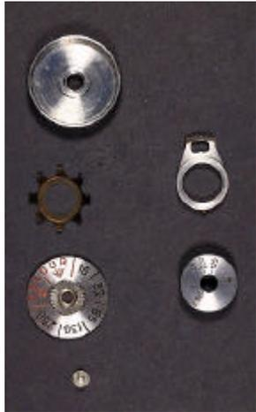
Bouton de rembobinage, rondelle-ressort, disque aide-mémoire et sa vis de fixation. Sélecteurs de vitesses d'obturation et de synchro-flash.
