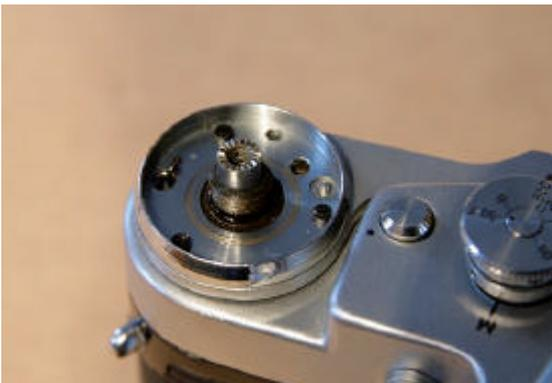
Inutile de retirer les 3 petites vis (noires), décrocher le ressort et retirer l'ensemble du levier d'armement.
