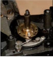
Voici la position que doit occuper la roue à trous lorsque l'obturateur est armé. Sa vis de fixation ne va que dans un seul sens (dans l'autre il est impossible de la visser à fond, ne pas forcer!!!)
