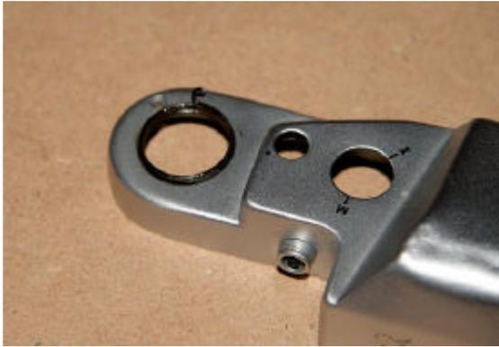
Le ressort reste sur le capot, on peut le retirer pour nettoyage et graissage, repérer son positionnement pour pouvoir le remettre comme il faut.
