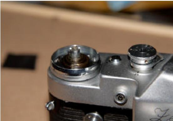
Une fois retirés le compteur de vues et sa rondelle-ressort, il faut maintenant dévisser l'écrou de maintien, là aussi c'est un pas inversé et il faut tourner dans le sens des aiguilles d'une montre. J'utilise un outil à démonter les objectifs, mais on peut aussi utiliser une pince à becs fins.
