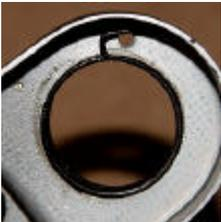
Vérifier la position du ressort avant de remettre le capot, pour qu'il vienne se caler contre la vis.
